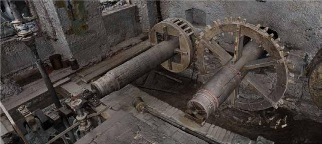
SfM-Bild des Antriebs- und Räderwerks sowie Saugpumpen in der Pumpenstube
